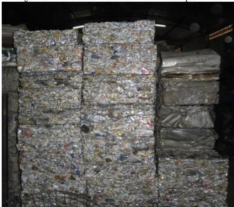
Imagem 16 – Acondicionamento de alumínio em fardos padronizados
